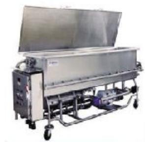
Permite la limpieza con alta concentración de detergentes y alta temperatura, sin necesidad de realizar acción mecánica manual, principalmente en piezas de difícil acceso.
