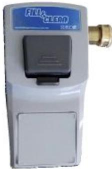
Es un equipo dispensador de productos químicos que dosifica la concentración seleccionada de manera automática. Existen dos tipos de Fill&Clean; de boton y de botella. Todas las partes que están en contacto con productos químicos son de polipropileno, viton, y EPDM.
