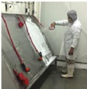
Para el control sanitario de acceso a las zonas de manipulación y producción de alimentos es fundamental para evitar la contaminación cruzada. Aplicación por medio de espuma.
